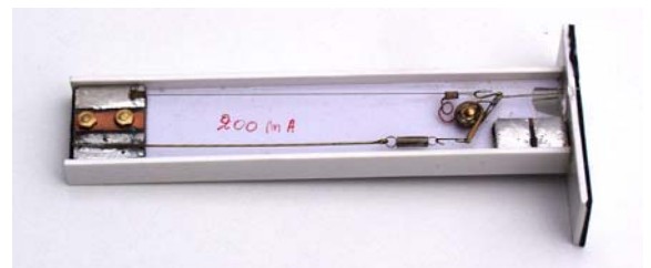
Moteur de signal avec fil à mémoire.
