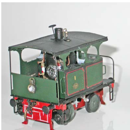
Foto's van het handmodel. in opbouw . Schuifbeweging « Walschaers » nog niet aangebracht.
